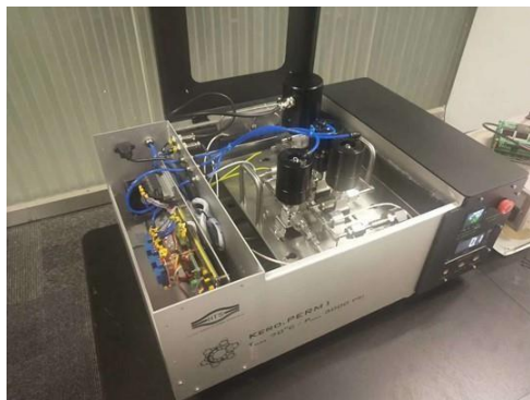
图 1. 新型储层岩石渗透率测量仪 （装配完毕后实物拍摄图替换）
